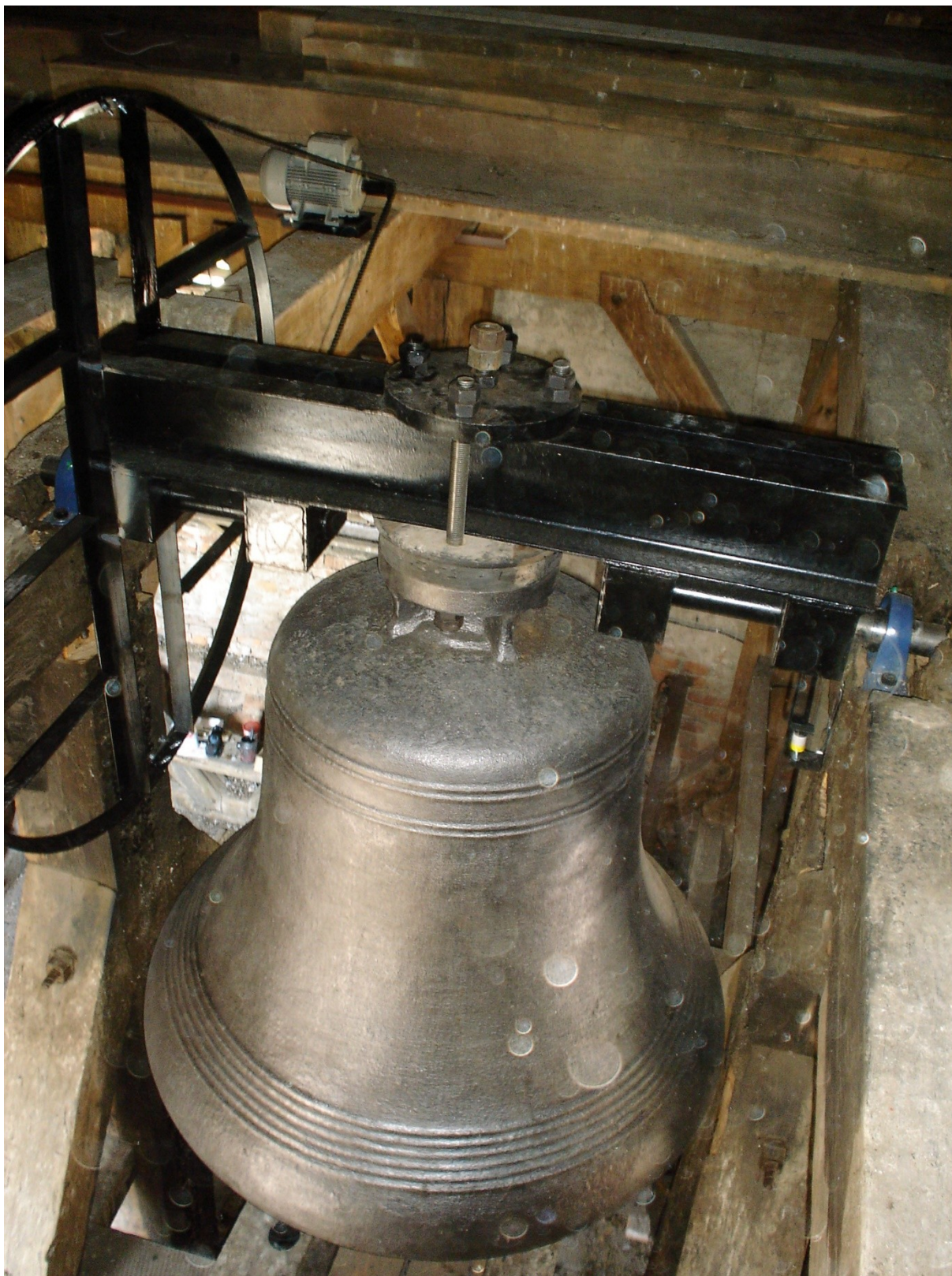
Ukázka asynchronního pohonu, kovový závěs
