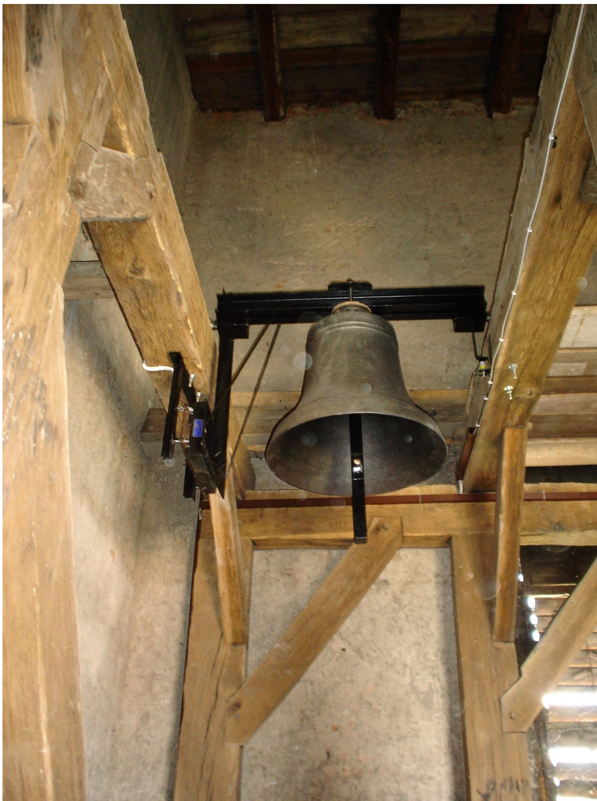
Ukázka instalace lineárního pohonu, kovový závěs
